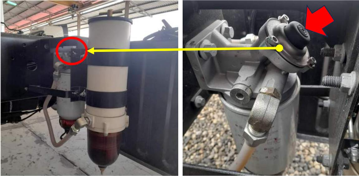
4. Cuando la bomba manual de combustible presente resistencia al accionarla, verificar que por el racor de purga este goteando combustible.
