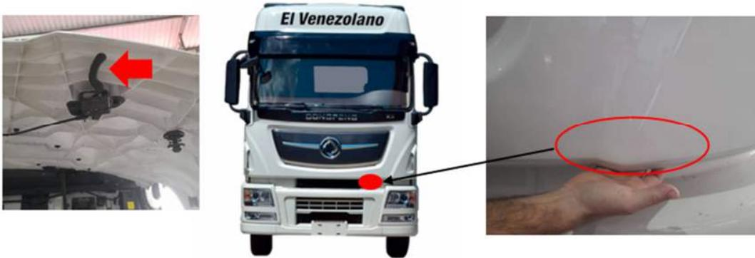
9. Levantar la tapa frontal de la cabina, para así evitar daños al momento de inclinar la cabina.
