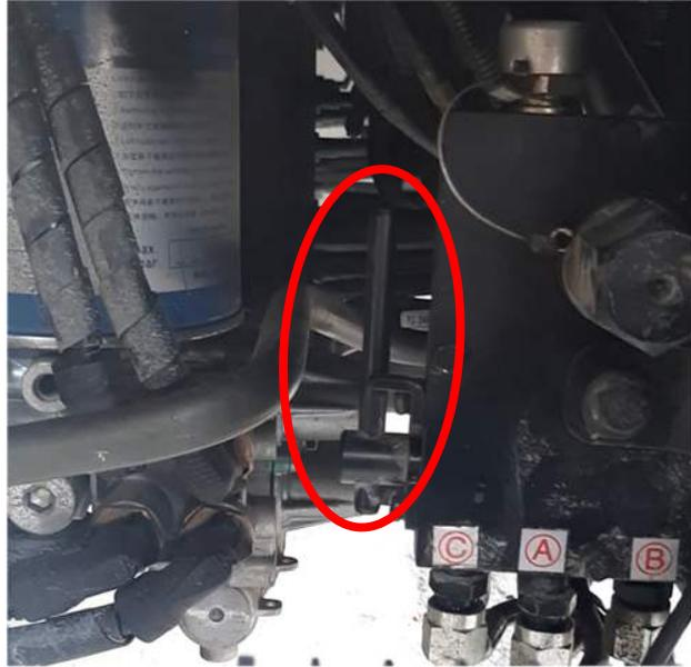
12. Ubicar en la parte frontal de la cabina, el conjunto del interruptor eléctrico de inclinación de la cabina, tomarlo y abrir su tapa.
