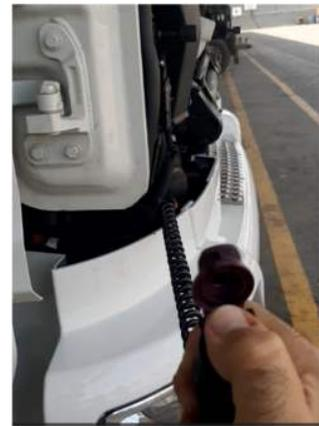
5. Colocar el conjunto interruptor eléctrico de inclinación de cabina en su posición correspondiente.
