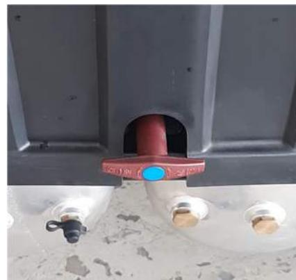
2. Girar la leva del mecanismo de inclinación de la cabina en sentido antihorario (hacia la izquierda) colocándola en posición horizontal.
