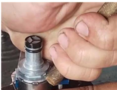
Instalar el solenoide y verificar que el sistema opere correctamente, de lo contrario realizar la acción 2.
