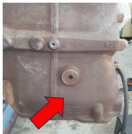
Tapón de llenado, ubicado en la parte superior
