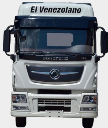
**01** Cabina full ergonómica con camarote doble + cabina sobre motor que mejora los radios de giro.
