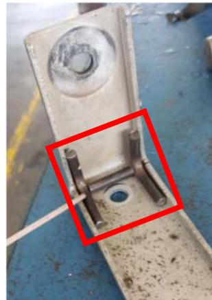
2. Sustituir la abrazadera del silenciador.
