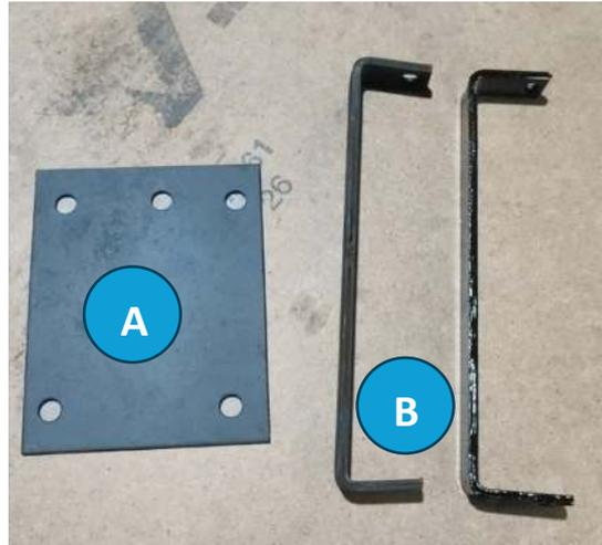
Una vez instalado el kit de reparación, reajustar los tornillos a los 10.000 Km / 200 horas / 3 meses. **Par de apriete: 55 Nm**
