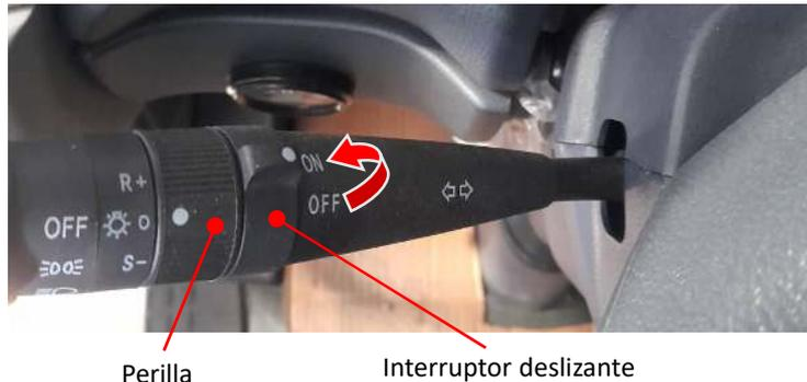
3. Girar la perilla hacia arriba (R+, aumento de RPM) y hacia abajo (S-, disminución de RPM) para verificar el ajuste de las RPM
