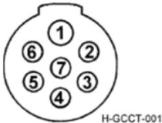
Disposición de los contactos de la toma de corriente del remolque
