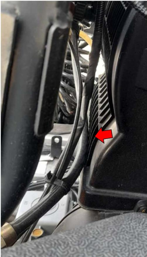
Al hacer la revisión, de comprobar que la manguera de combustible esta haciendo contacto con la carcasa del filtro de aire de motor, se debe realizar la acción correctiva del boletín de servicio **BS 027 234**
