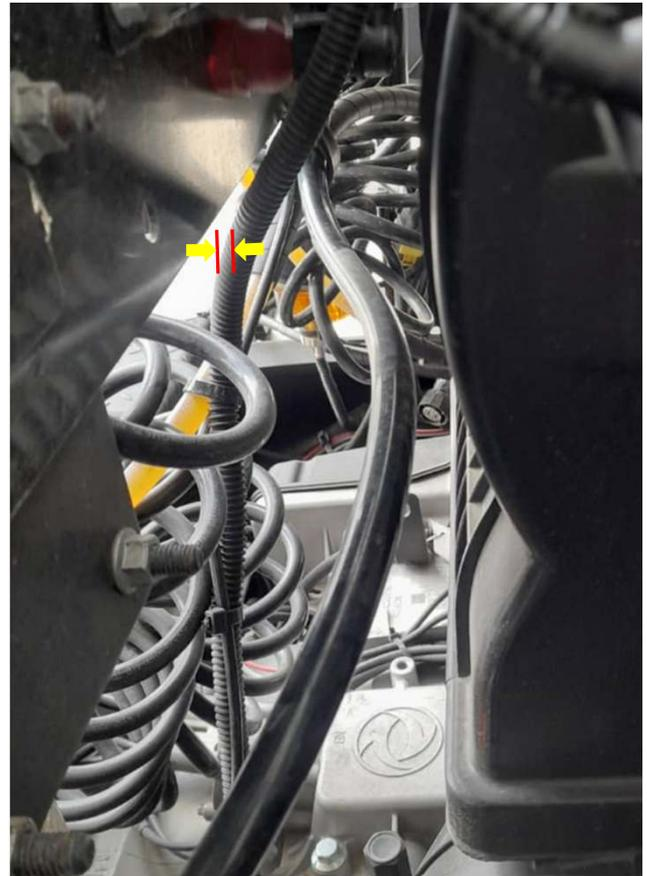
Es importante que la manguera de combustible no este en contacto con la carcasa del filtro de aire de motor, para evitar daños en esta.
