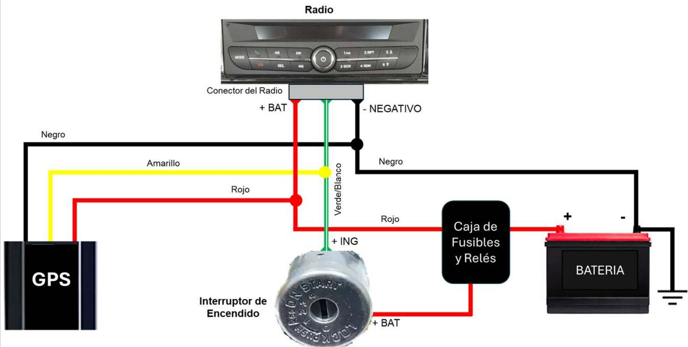
De los cables identificados del conector de la radio, empalmar con estaño los siguientes cables del dispositivo GPS:
