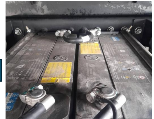
Remover los cables, primero el polo positivo (usar llave 13 mm)
