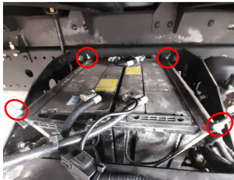
Remover las 4 tuercas y contratueras de la placa de fijación y desmontar las baterías (usar llave 13 mm)
