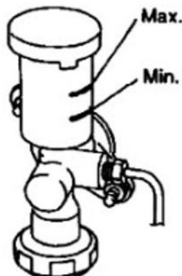
3. Compruebe si las líneas hidráulicas y las conexiones del cilindro de operación son normales y si hay grietas, daños, juntas sueltas, desgaste o corrosión.
